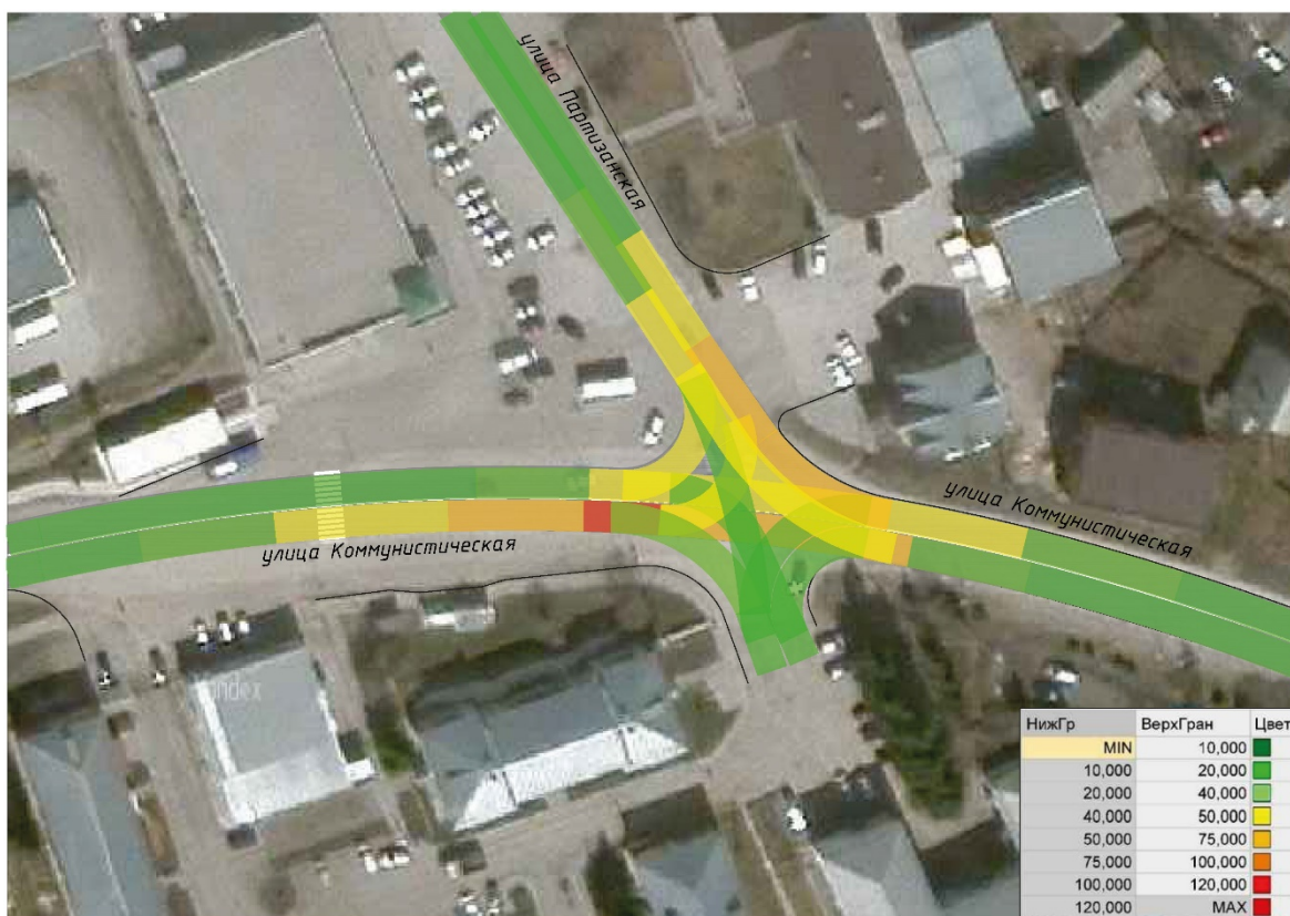
Рисунок 4.18.4 – Картограмма плотности транспортного потока на моделируемом узле
