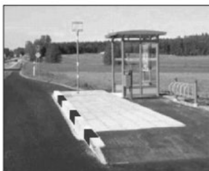
Рисунок 4.16.5 – Пример обустройства остановочного пункта пандусом
